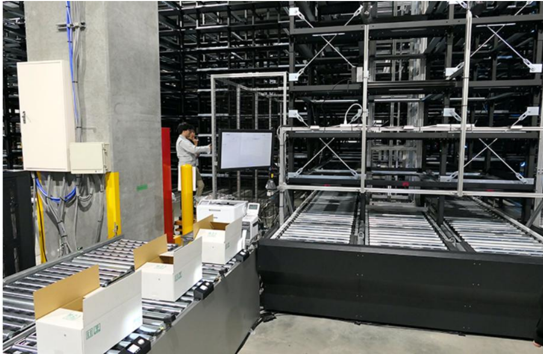
圖 8、RENATUS 自動機器人倉儲系統 Goods to Person 示意圖
