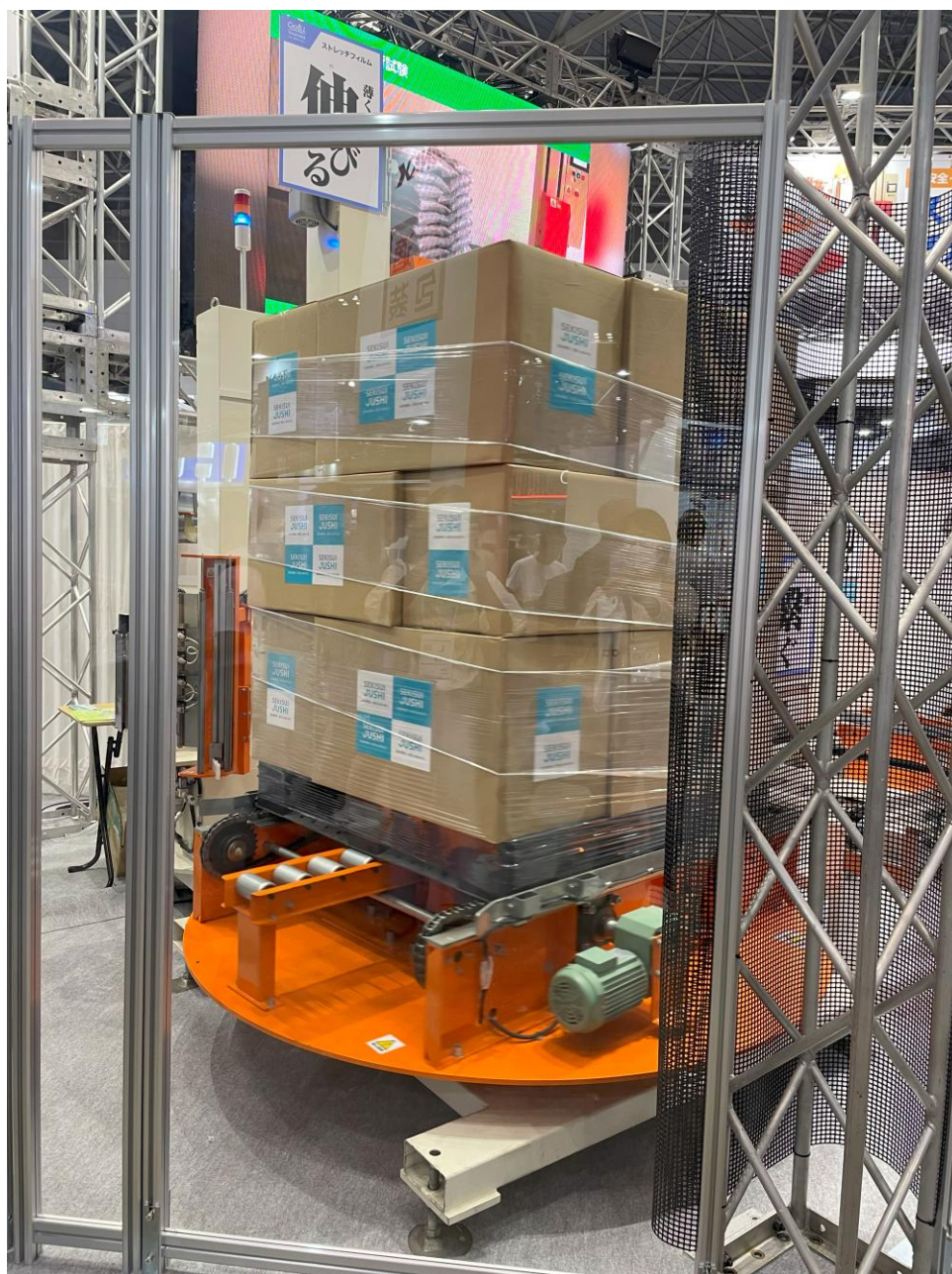
圖 55、自動捆裝系統示意圖
