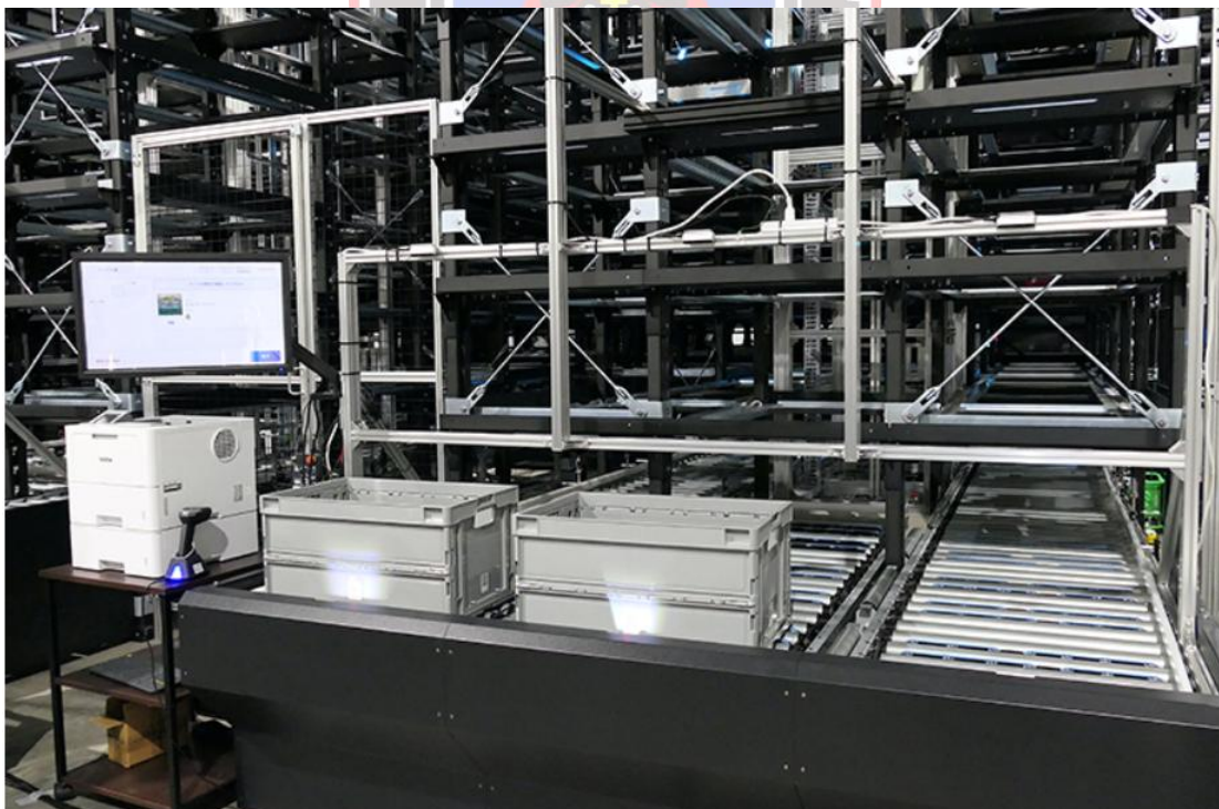
圖 7、RENATUS 自動機器人倉儲系統示意圖
