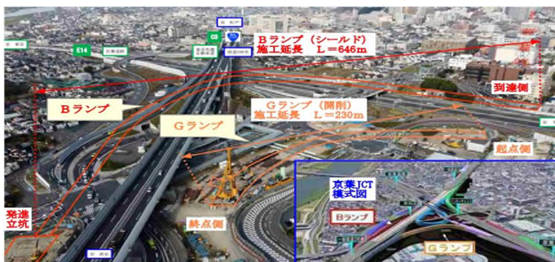
京葉交流道 B 匝道工程平面示意圖(鹿島建設株式會社資料)
