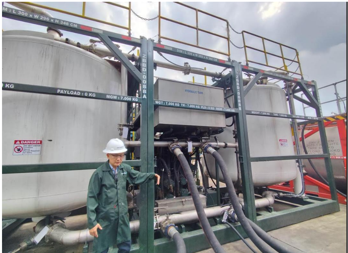
圖10. Baker Hughes 人員向與會人員介紹水泥攪拌桶，可供應相當體積之水泥乳亦可進行攪拌，特別適用於顆粒較大、易沉澱之水泥乳，如矽砂水泥、抗酸水泥等。
