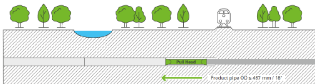
圖 8 E-Power 施工步驟第二階段：回拉臨時鋼製頂管並同步拉入管線
