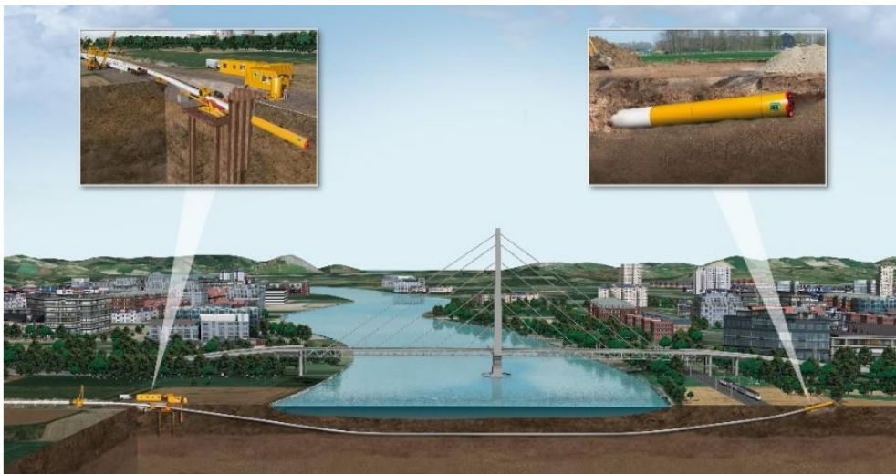
圖 6 Direct Pipe 之作業原理
