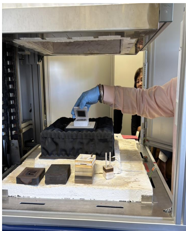
圖 20、單一電池單元高溫測試平台
