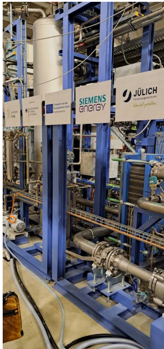
圖 13、Julich與西門子能源合作之MW級PEMEC示範系統
