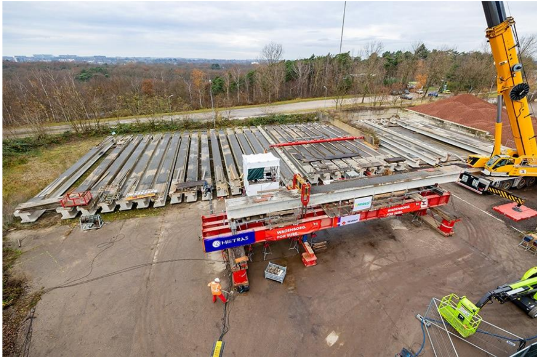
圖片說明：A9 高速公路使用之舊混凝土梁，拆卸後集中存放，並進行安全性能檢測。圖片來源： https://betonenstaalbouw.nl/ 。
