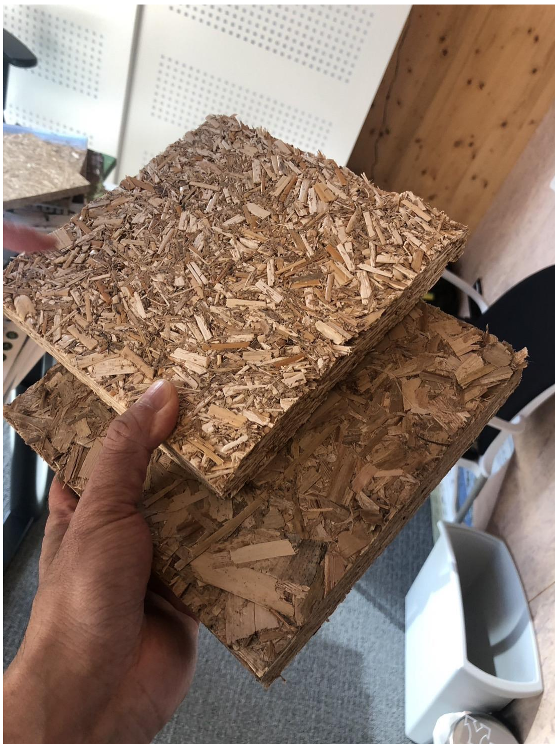
圖片說明： Ms. Petra Boorsma 執行長提供，不同混合比例、植生物種、裁切纖維之「濕地作物循環生物質營建材料」樣品原型（Prototype），屬於促進自然資源保育與環境保護為目的，節省能源、節約資源、減少溫室氣體排放之技術規格。
