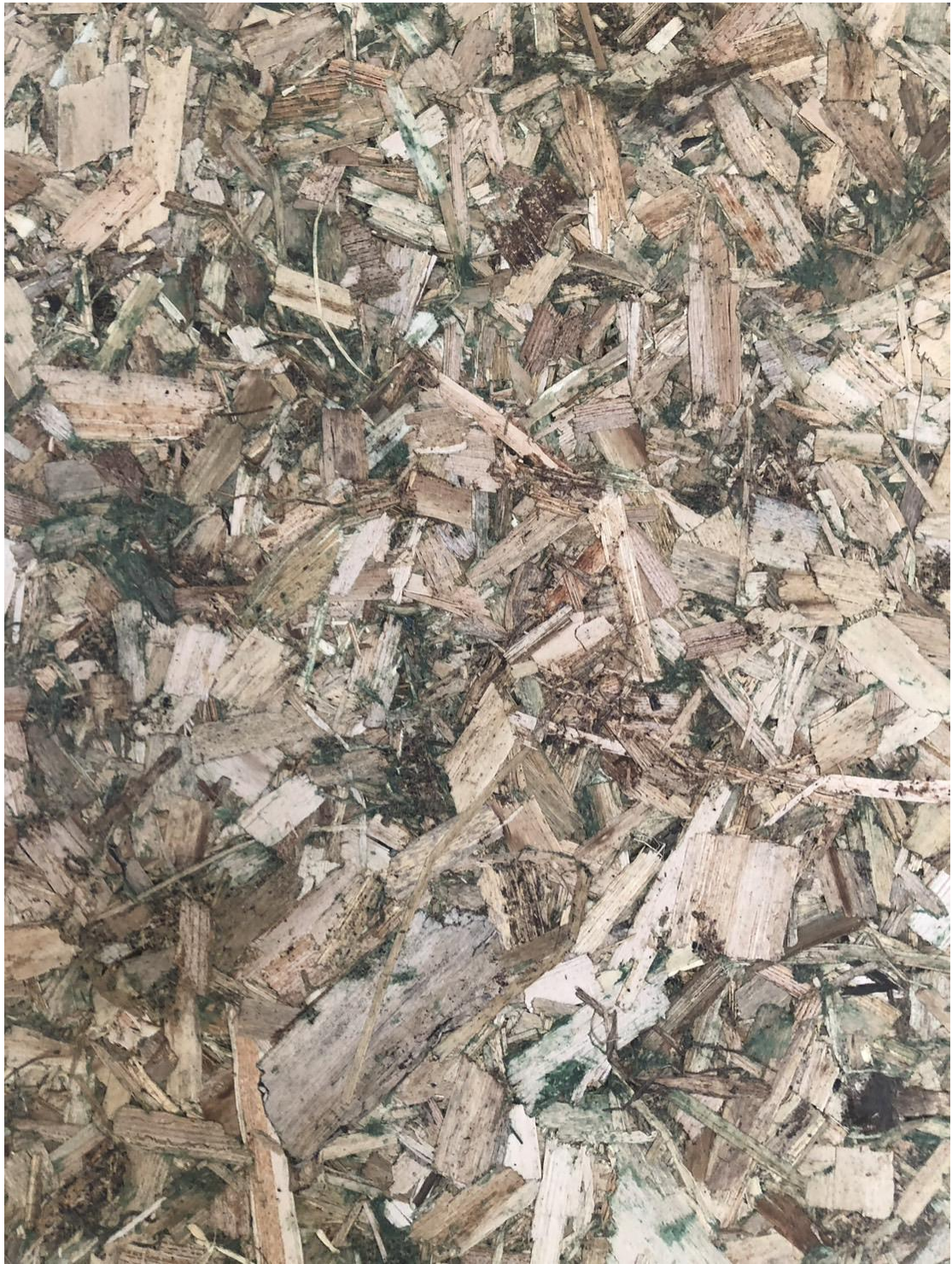
圖片說明： Biosintrum 中心研發中之「濕地作物循環生物質營建材料」，具有水生植物特殊紋路，可用於立面及室內隔間板材，屬於促進自然資源保育與環境保護為目的，節省能源、節約資源、減少溫室氣體排放之技術規格。
