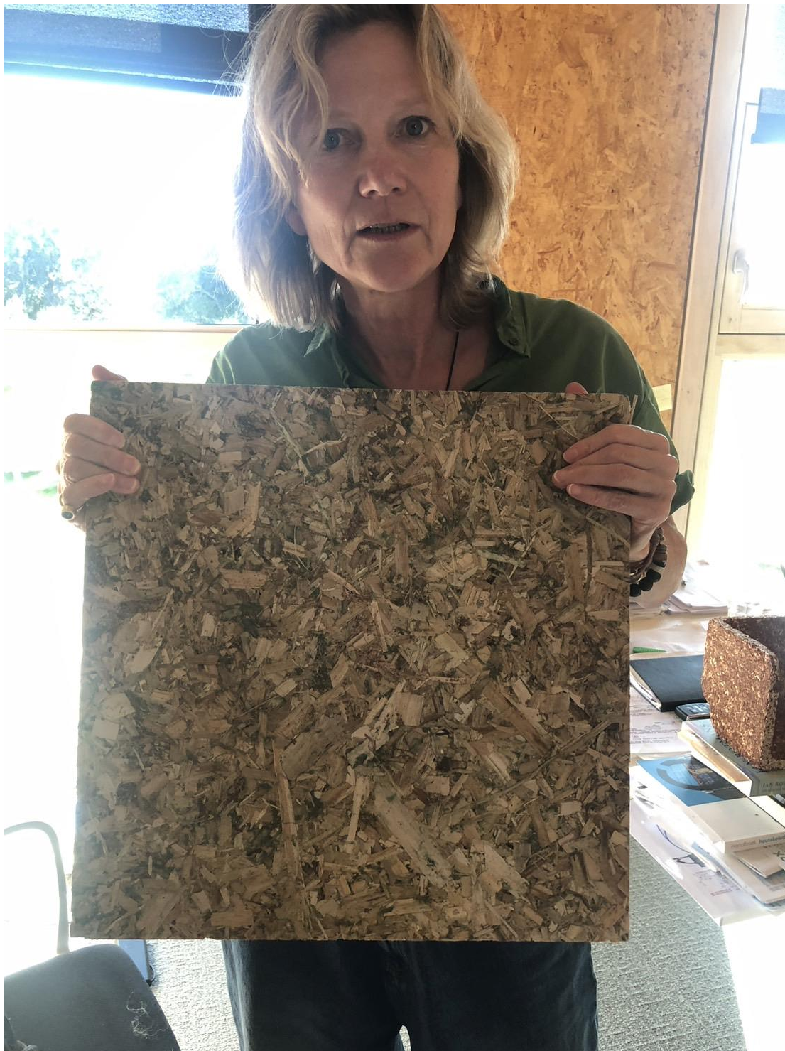
圖片說明： Ms. Petra Boorsma 執行長解說，研發中之「濕地作物循環生物質營建材料」，可用於立面及室內隔間板材，屬於促進自然資源保育與環境保護為目的，節省能源、節約資源、減少溫室氣體排放之技術規格。
