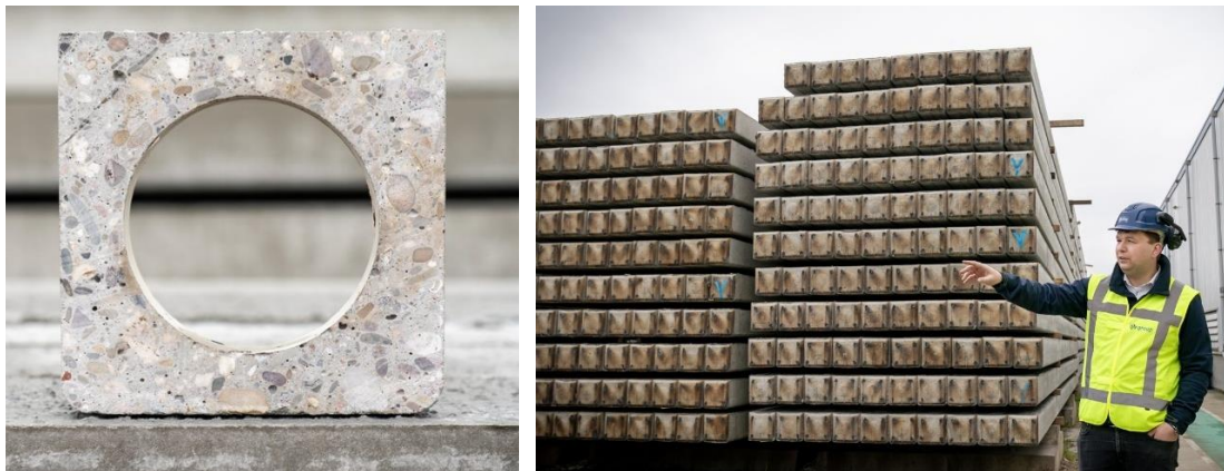
圖片說明：案例 2，基樁分包商 Lemmer 的 IJB Groep，配合進行減碳轉型，共同設計中空混凝土之 ECO 樁。圖片來源： Heijmans 。
