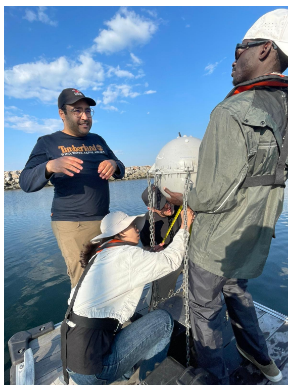
圖 28、以檢校板（Bar check）檢校單音束測深儀 HydroBall
