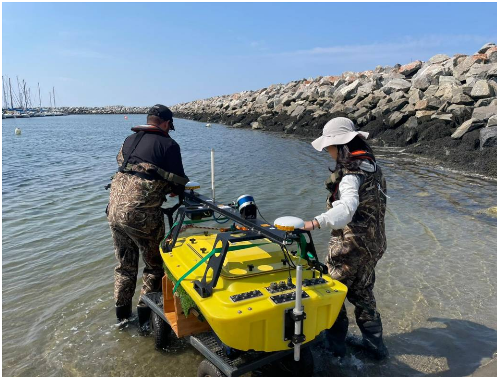
圖 35、透過下水坡道將無人船放進水域
