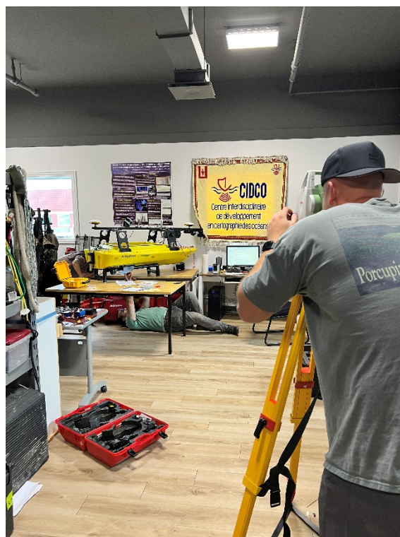
圖 8、對無人船（ASV）進行軸臂（lever arm）靜態校準測量
