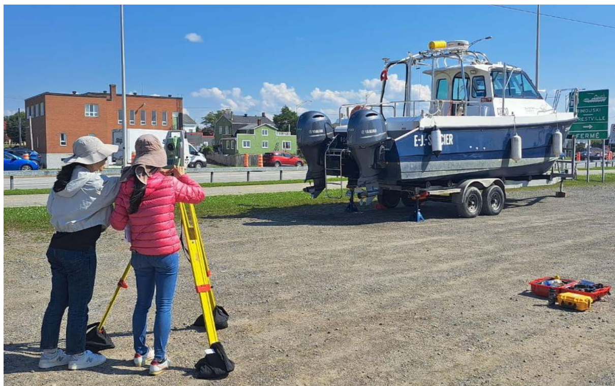
圖 26、對測量船進行軸臂（lever arm）靜態校準測量
