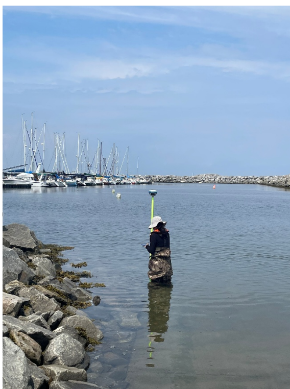
圖 24、即時動態定位（RTK）測量下水坡道水深極淺處
