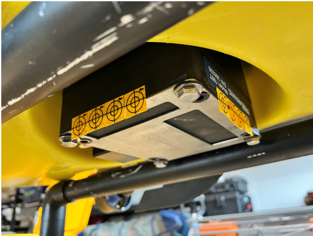
圖 7、無人船（ASV）底下裝載多音束測深儀並貼有校準標籤
