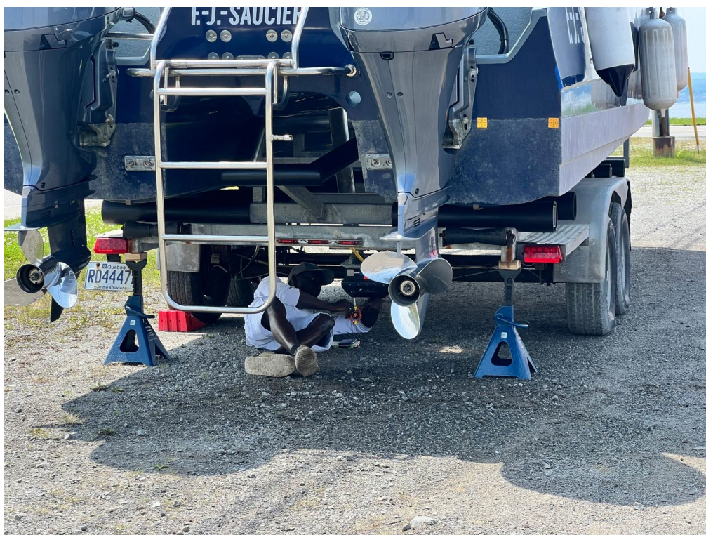
圖 27、進行靜態校準測量時於船底多音束測深儀擺放稜鏡
