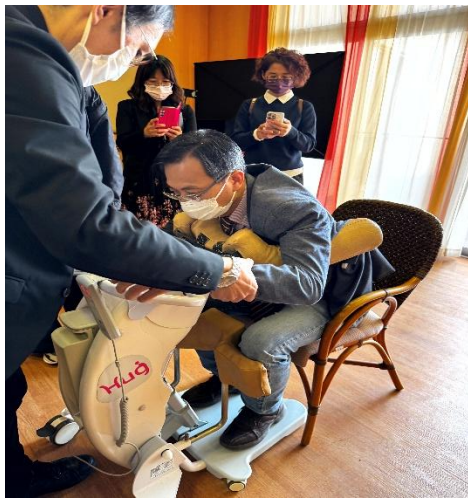
適合有部分肌力長輩之移位支援機器(HUG)，從坐姿趴著機器到扶起來
