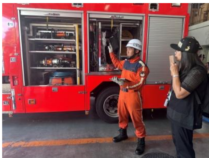
圖 60. 介紹消防車上的破壞器材及各式救助器材配置情形 (1)
