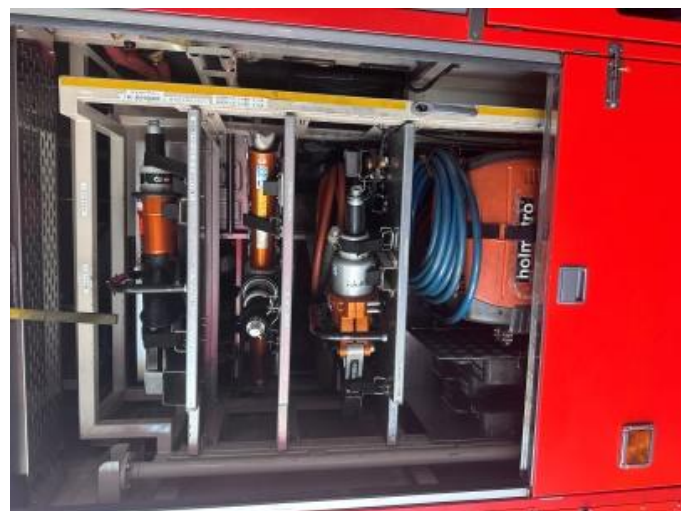
圖 61. 介紹消防車上的破壞器材及各式救助器材配置情形(2)
