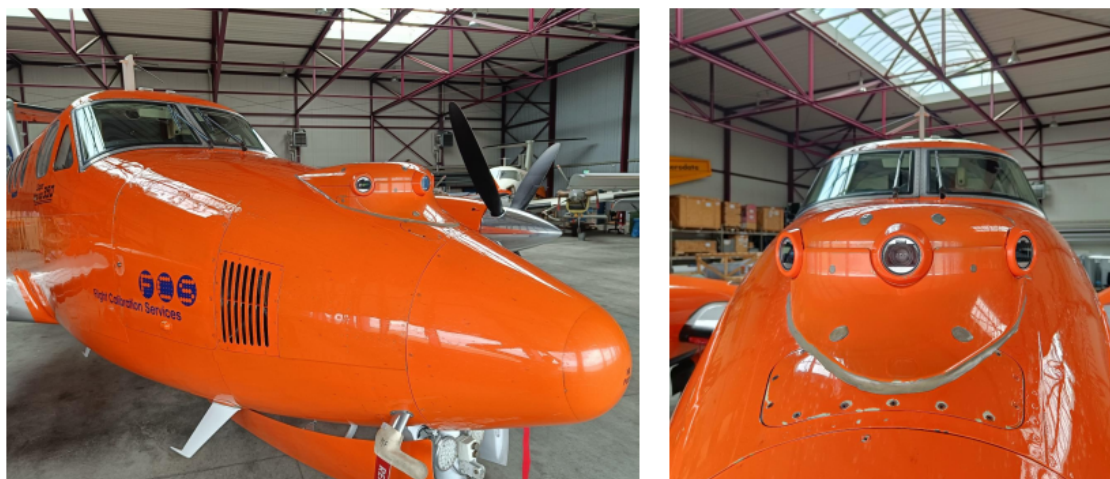
圖 2 飛測機安排攝影鏡頭正面及側面
