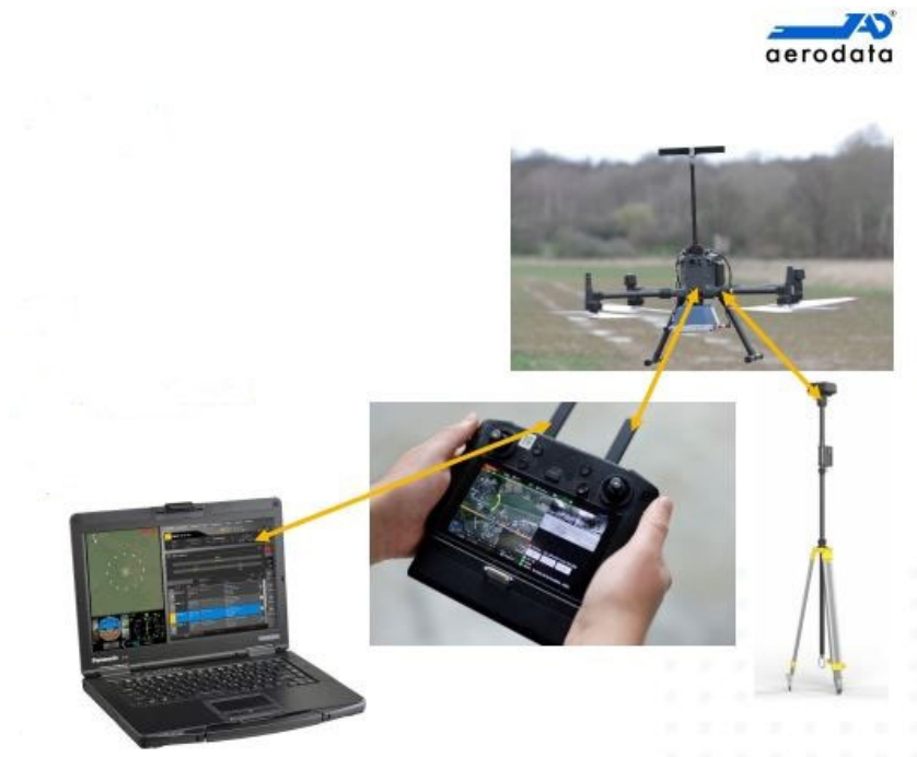
圖 1 無人機執行飛測任務之架構
