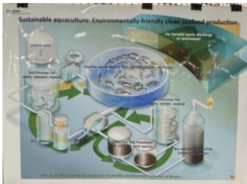
圖六、整合循環水養殖（RAS）與沼氣能源回收系統設施說明圖示。
