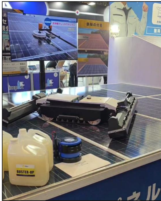
圖6 太陽光電板清潔機器
