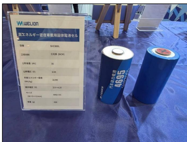
圖12 高能量密度汽車固態電池
