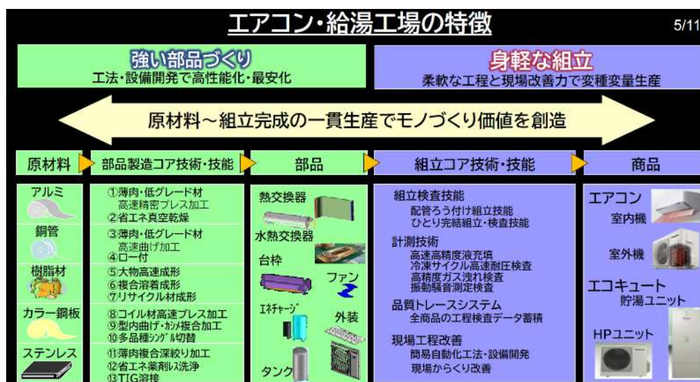
圖 42、空調和熱水供應工廠一體化生產方式
