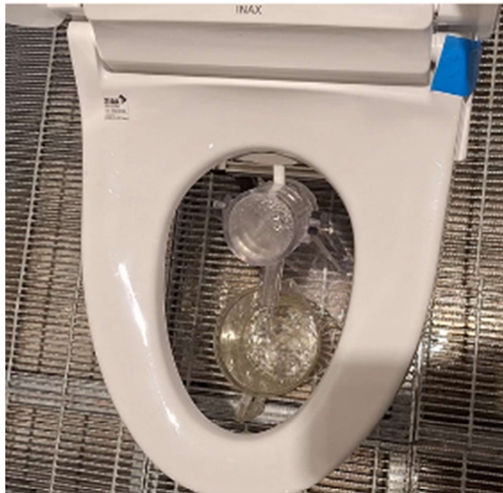
圖 11、噴嘴伸入接收器內，開啟計時器並進行噴洗
