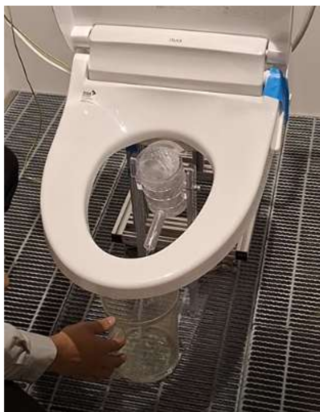
圖 10、容器放置於接收器的出水口下方
