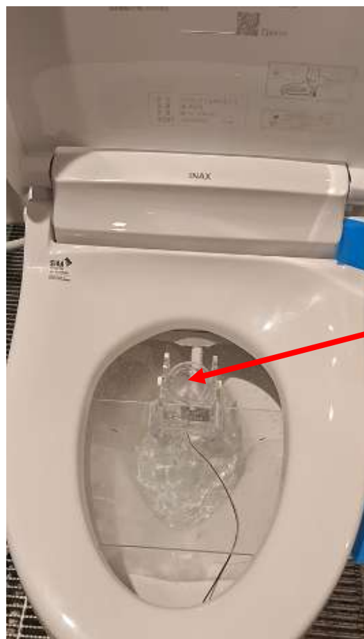
圖 6、噴洗性能-噴洗接收器量測水溫
