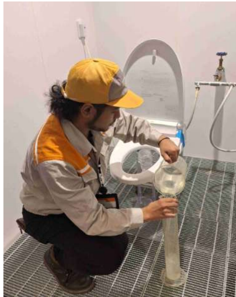
圖 12、容器的水倒入量測瓶內讀取刻度
