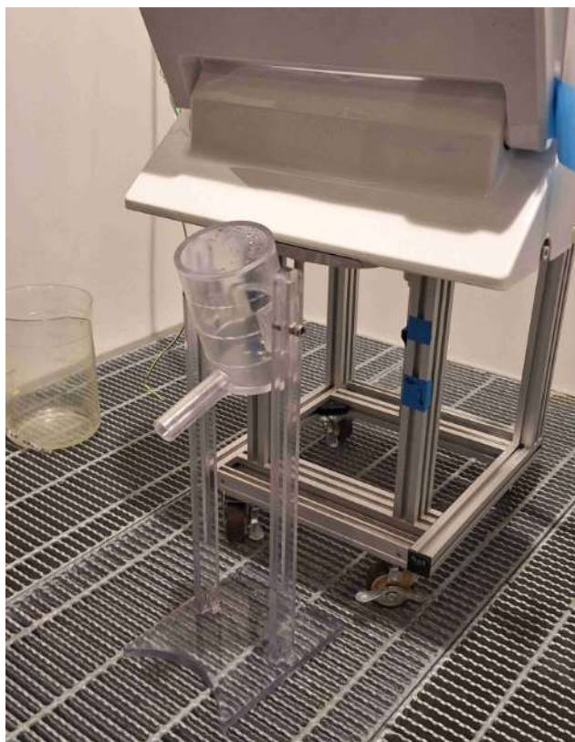
圖 9、驪住自製的水流量接收器
