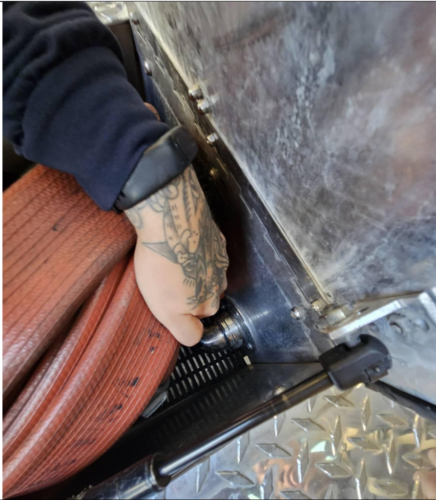
圖-水帶一端已經永久連接到消防車上的泵浦與水源系統
