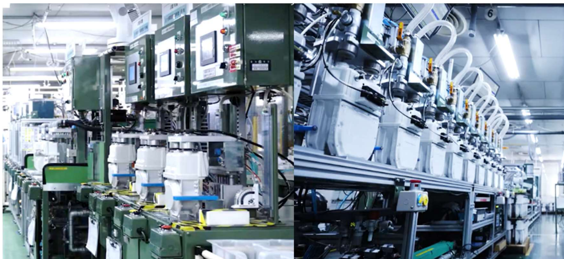
圖 18 氣量計氣密測試及器差檢測設備類圖
