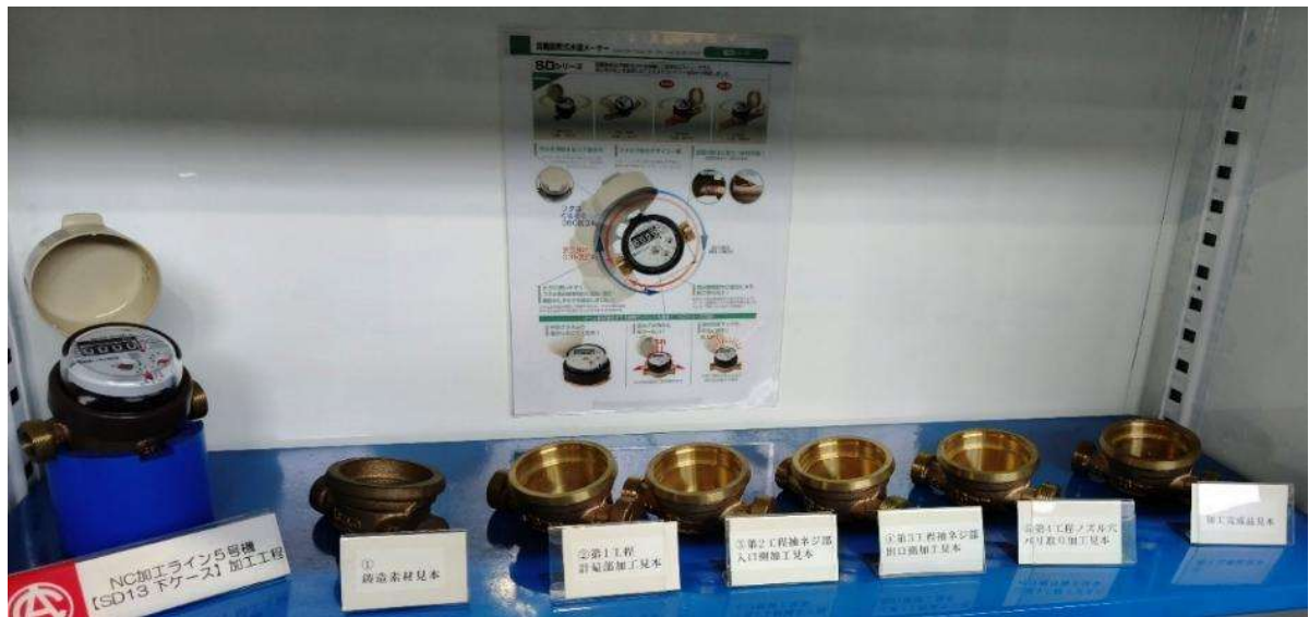
圖 10 SD 系列旋轉顯示型水表下殼（本體）加工步驟
