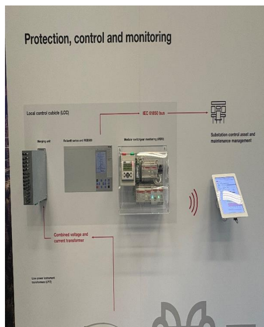
圖十七 數位變電站保護與監控示意圖
