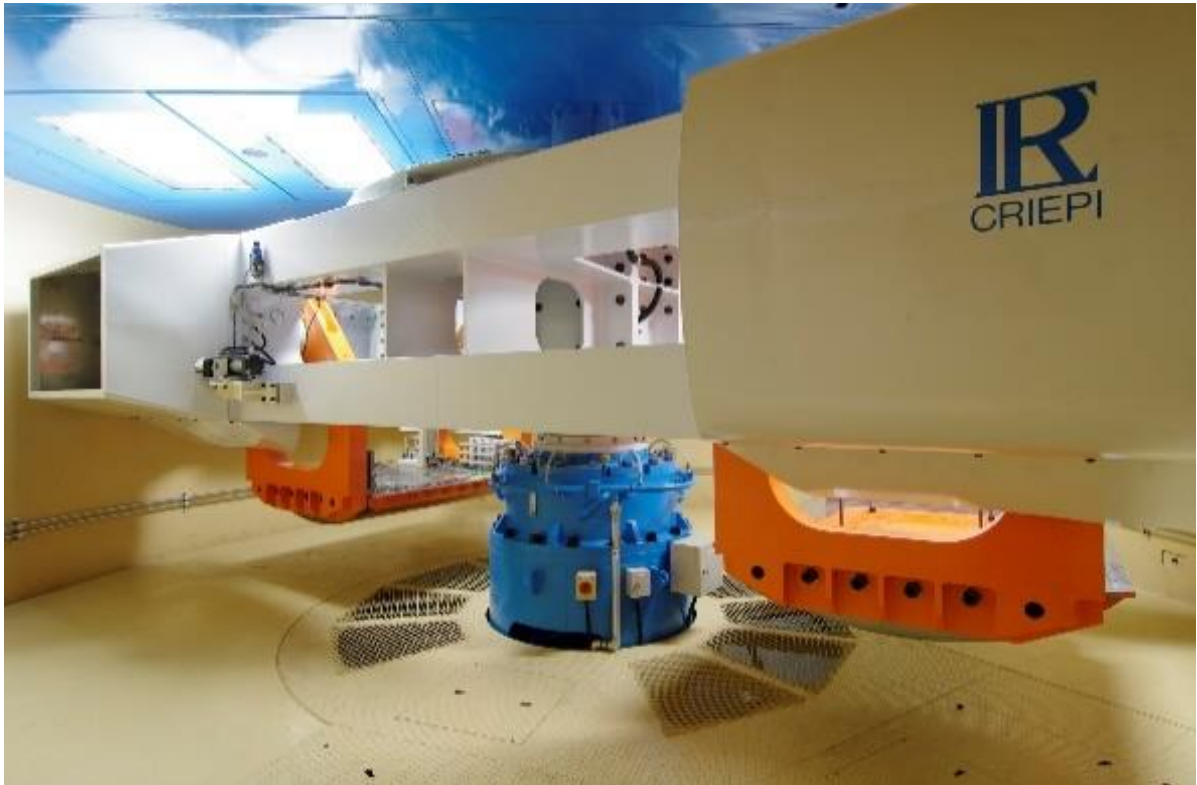
圖 3-6 遠心力載荷岩盤模型試驗裝置
