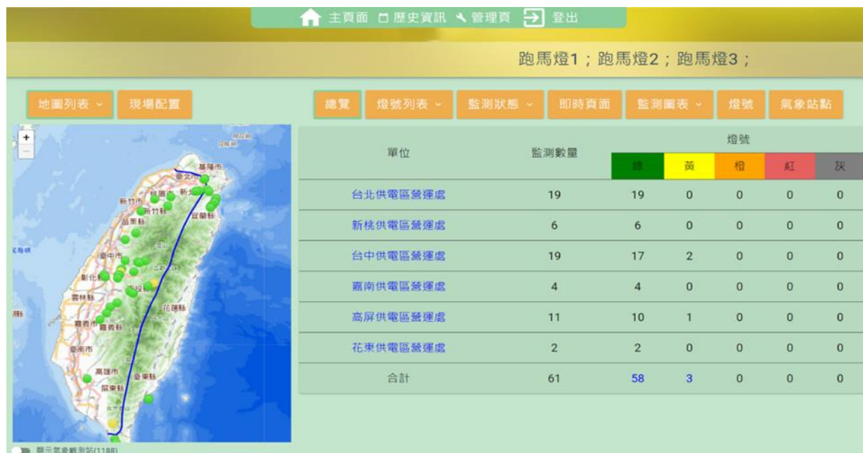
圖 2-21 本公司「三值四級制預警機制」直覺化呈現危害風險等級的即時監測資訊平台
