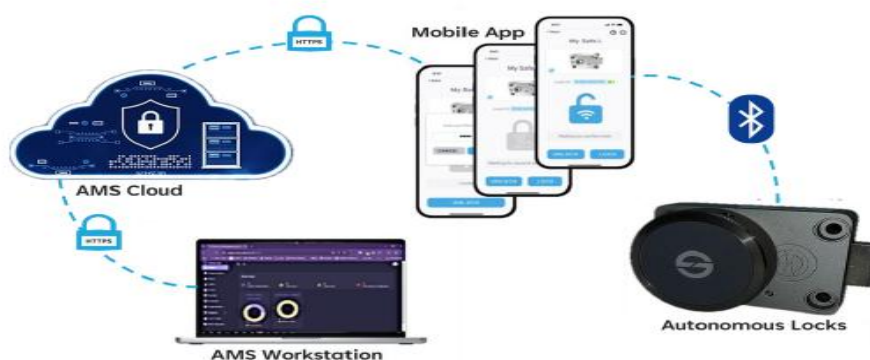
圖 15 高安全性鎖具的雲端暨行動整合式存取控制架構
