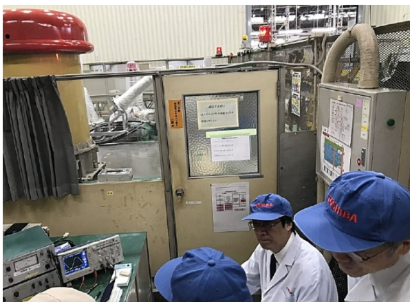
部分放電測量
