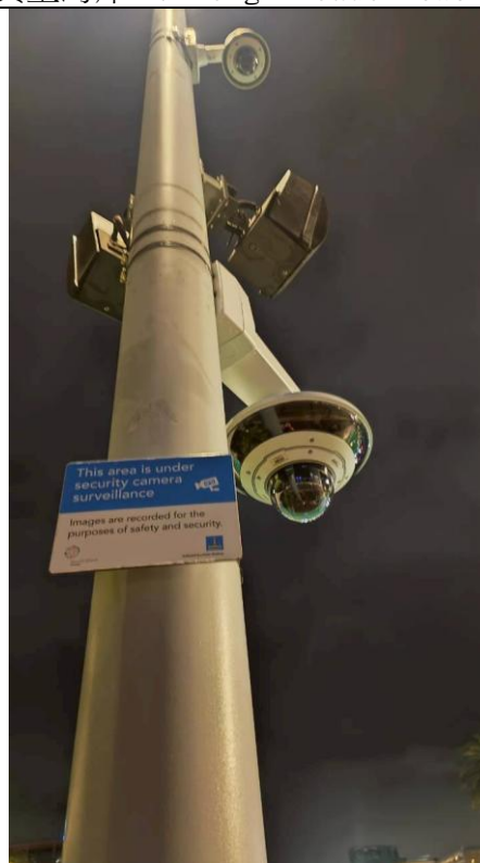
說明：位於澳洲布里斯本南岸沙灘之 AI 溺水辨識監視器。
