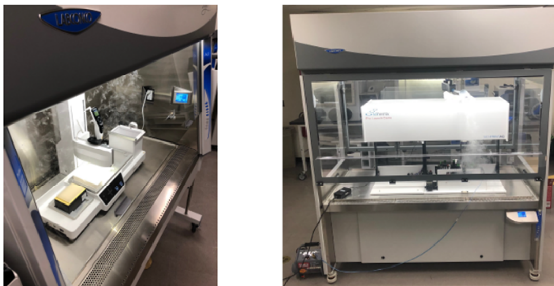
圖 3. 利用可視覺化煙霧檢測非典型生物安全櫃示意圖。
