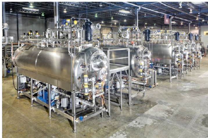
圖 5. Large batch 型廢液處理系統。
