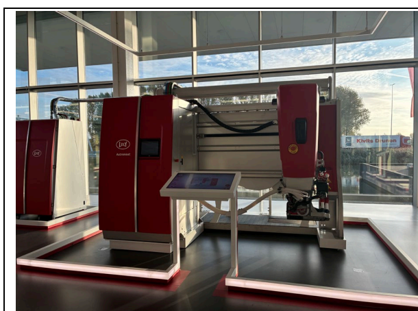
圖 36. Lely 自動化擠乳系統的模擬和介紹
