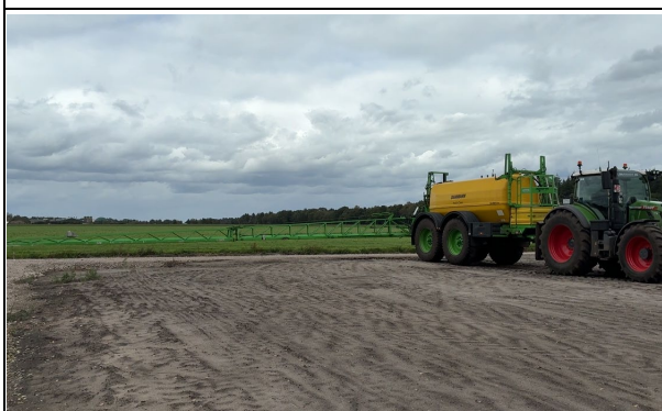
圖 22. 大型噴灑機可因應天候及作物類型調整噴灑高度，並結合 BBLeap 精準噴霧技術實踐精準農業
