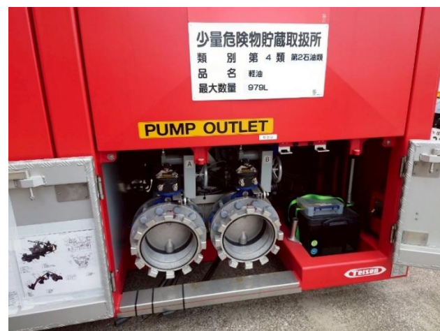
圖 38 幫浦運送車所載運之大型幫浦，出水口管徑達 12 吋，可以於短時間內輸送大水量供救災使用
