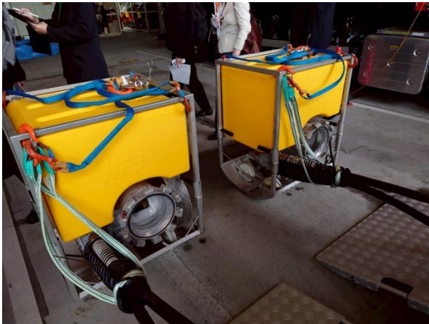
圖 39 可抽取大流量海水之沉水幫浦，水口徑為 10 吋，抽水量可達每台每分鐘 30 萬公升
