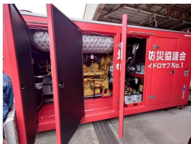
圖 37 幫浦運送車內部情形，係以車輛載運大型幫浦設備至災害現場部署
