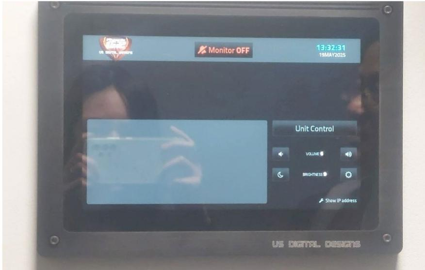
圖 14、控制面板(面板上可以選擇該消防人員當天受指派的車輛，例如 Engine(水箱車)、Ladder(雲梯車)…等，並限制該間寢室僅會連動到該車輛受派遣時的警報)
