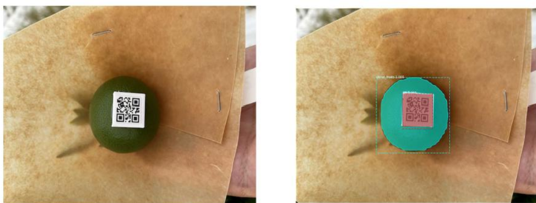
圖 6. 利用智慧型手機準確估算果實直徑的影像辨識與量測方法 (Komiya et al., 2025)。
