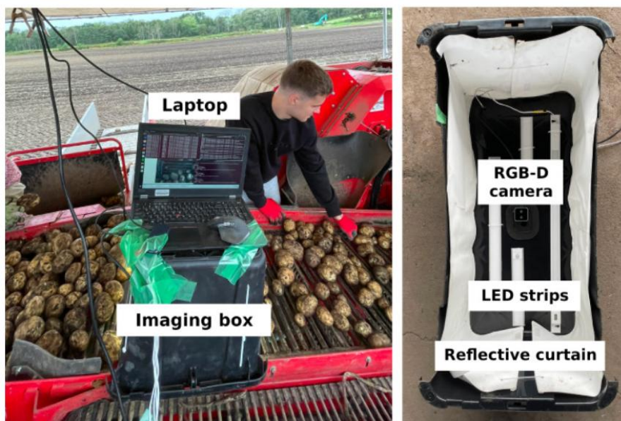
圖 2. 架設於收穫機上的 RGB-D 相機與機構 (Blok et al., 2025)。
