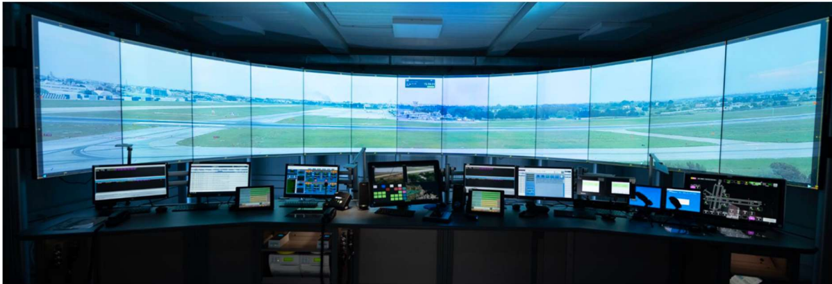
圖 20. ENAV 數位塔臺管制室配置 (資料來源：ENAV)
