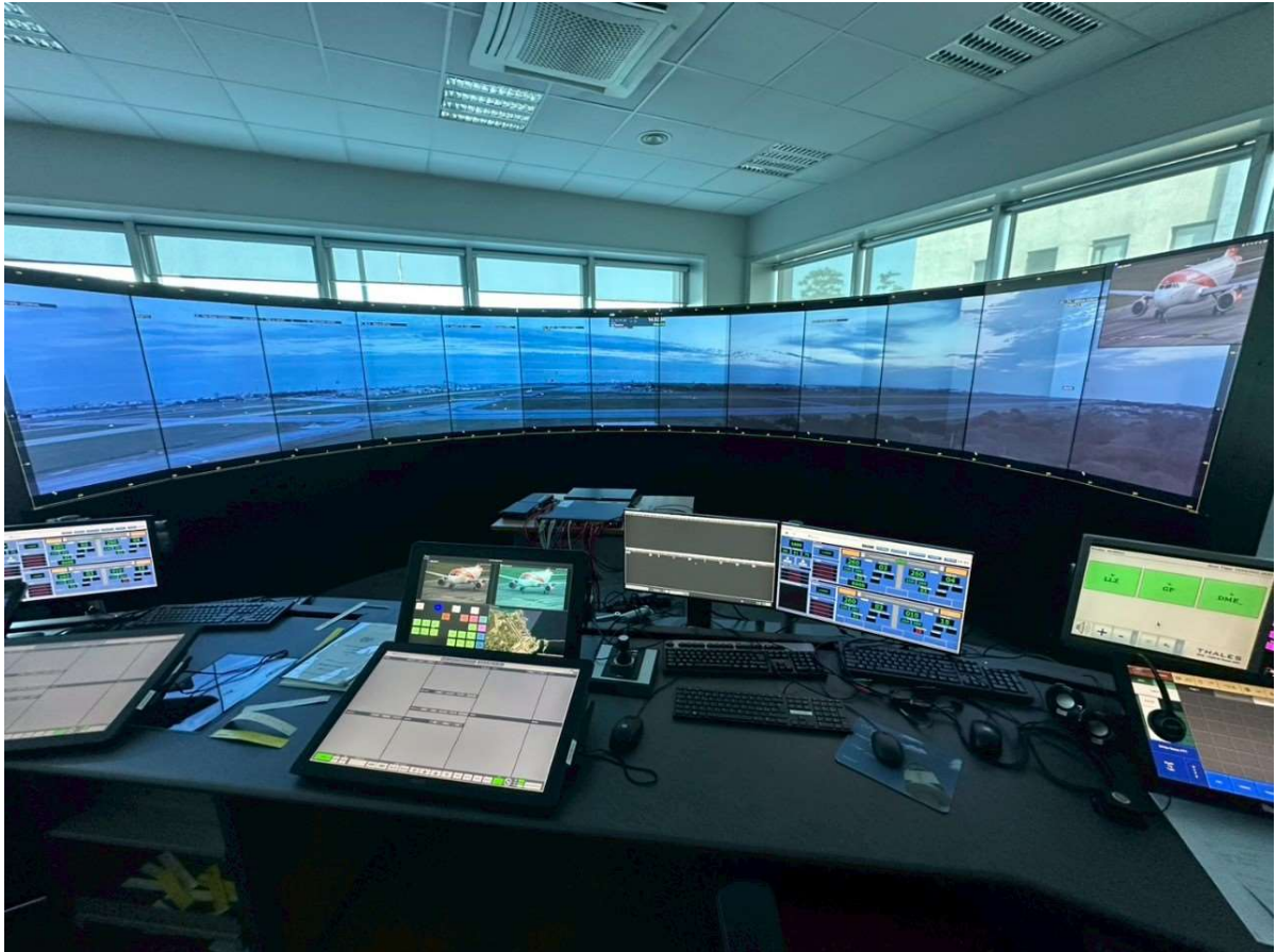
圖 6. ENAV 位於尚皮諾中心之遠端數位塔臺實體展示席位設備
