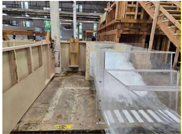
圖 62、測試抗穴蝕消能塊設計成果
