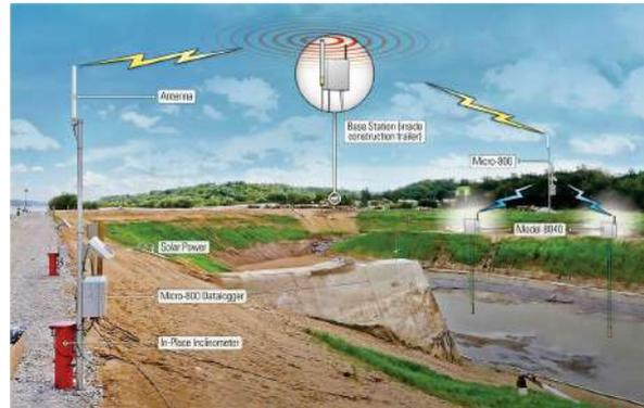
圖 22、儀器自動化測讀架構
