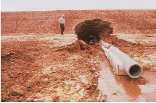
圖 13、沿出水管道內部沖蝕的破壞案例
