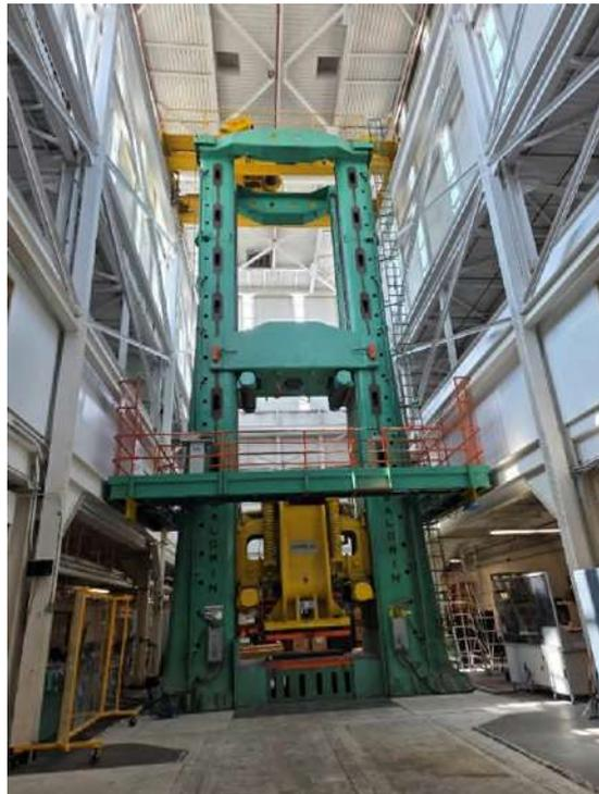
圖 64、Baldwin 大型載重試驗機
