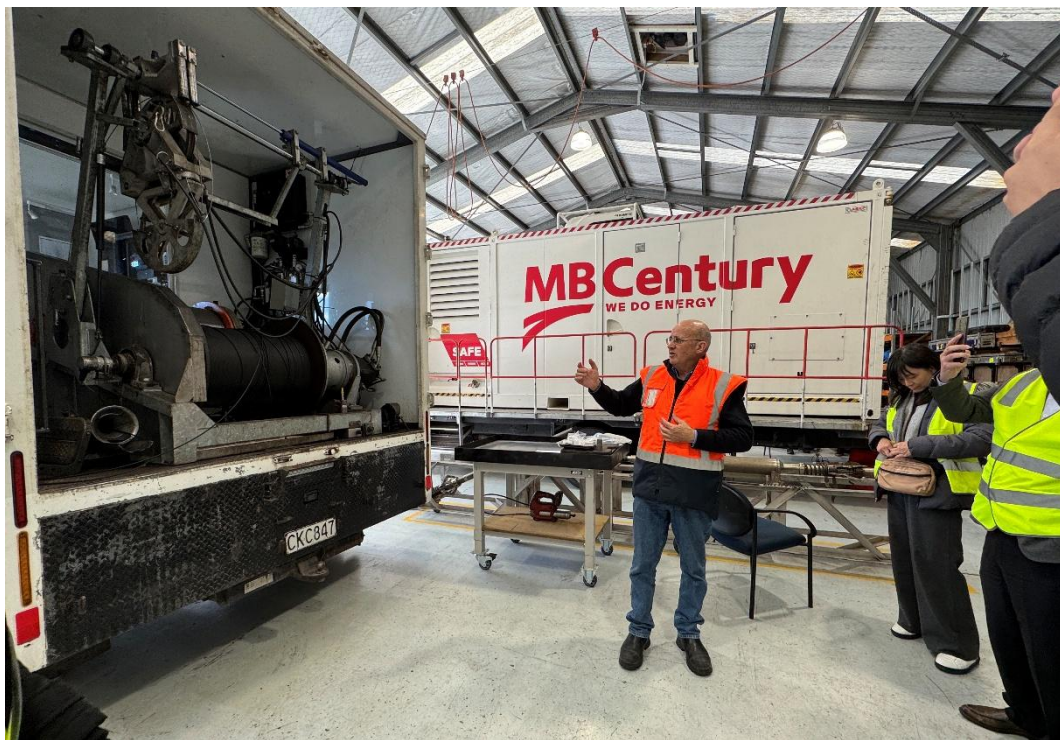
隨車鑽井設備
