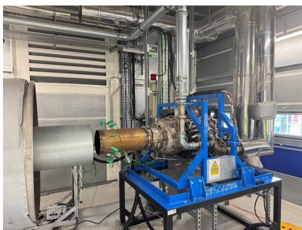
圖41、利用輔助發電機進行傳統燃料與SAF比較測試
