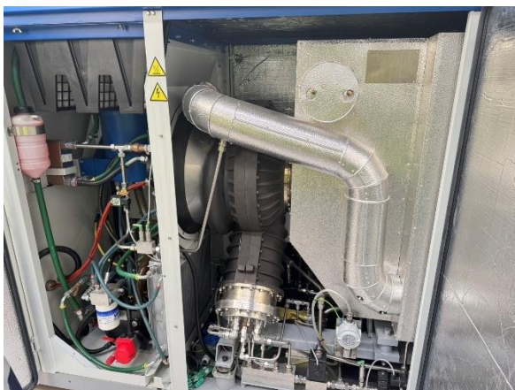
圖40、一般燃氣輪機組之氫氣混燒試驗
