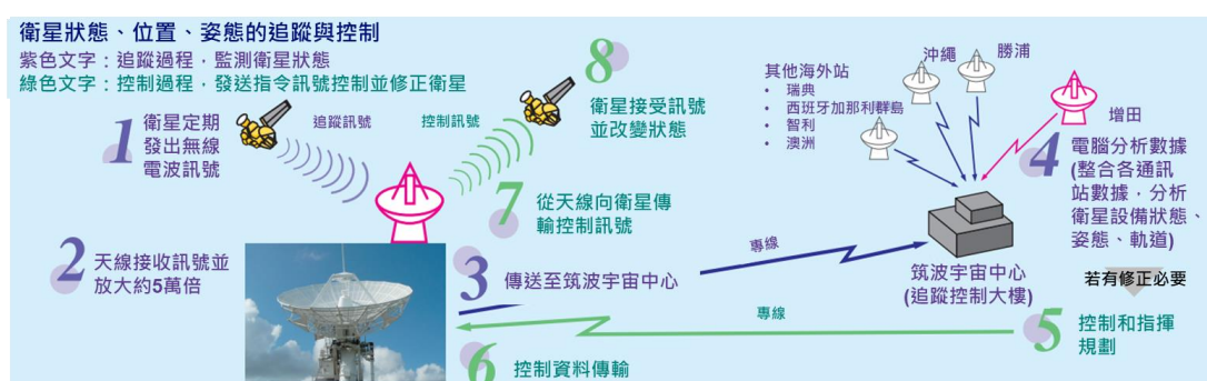
圖 15 衛星追蹤控制的角色分工
