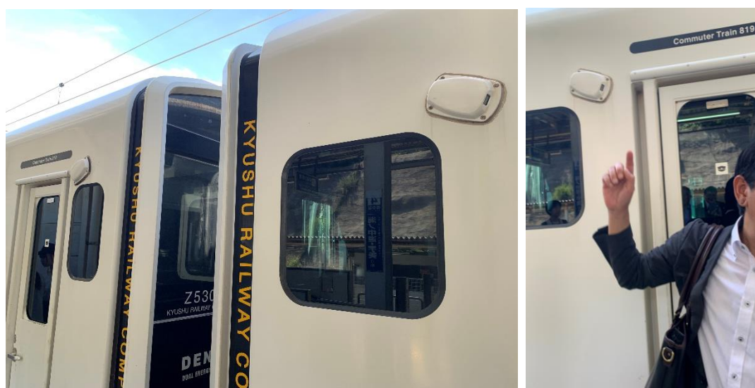
圖 24 採單人駕駛之香椎線電聯車設有車側監視器
