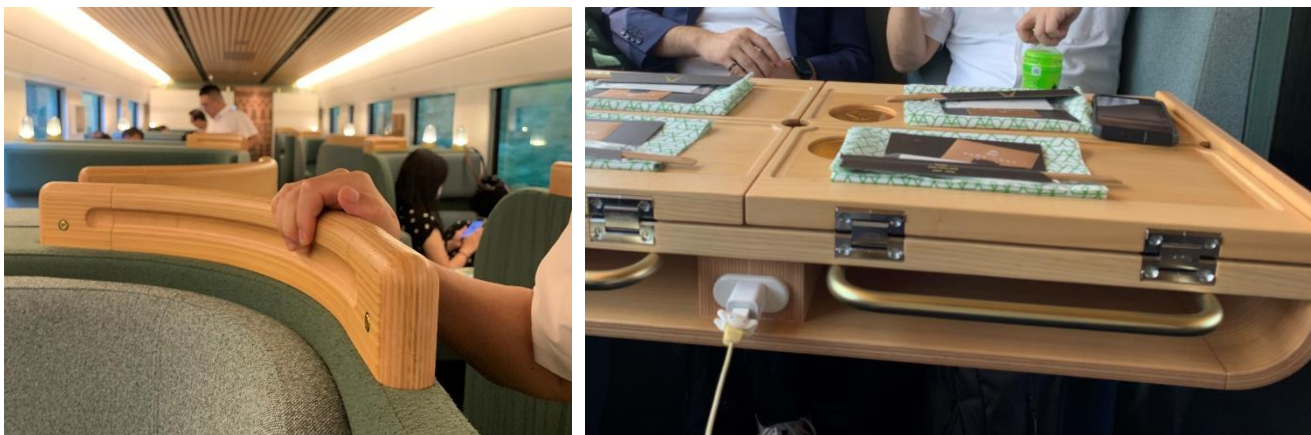
圖 44 車廂座位設有充電座、採用折疊式桌面且處處設置扶手以便旅客活動
