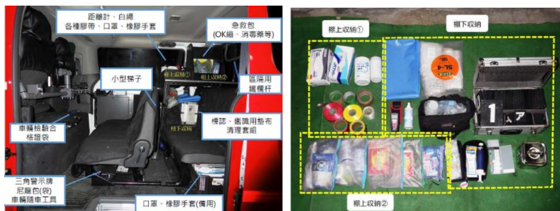
圖 10 箱型車款火災調查車中間座位區部分配置
