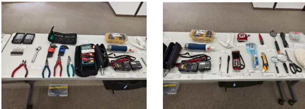
圖 68 四谷消防署火災調查現場勘察工具 5
