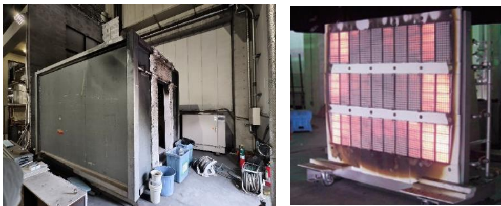
圖 47 房間角落火災測試單元及 ICAL 試驗裝置
