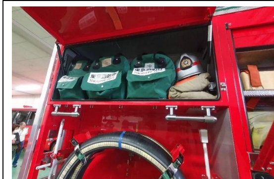
圖 30.消防車上配置基本 NBC 應變設備
