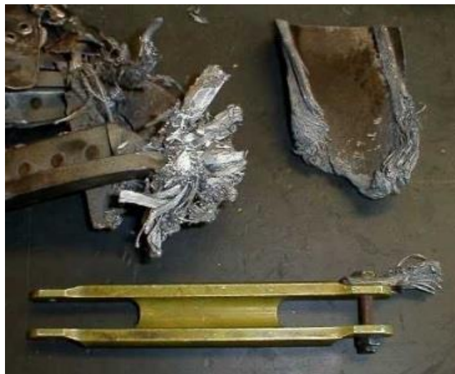
圖 4-1 鋁合金共晶熔化後開裂
