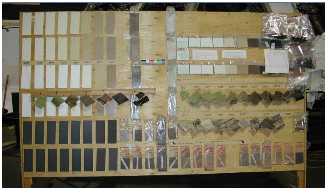
圖 4-6 比對用之不同鋁合金試驗樣品
