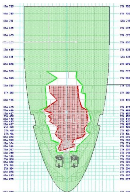
圖 4-7 結構受熱損壞範圍
