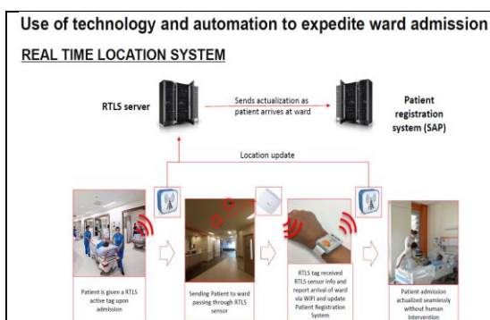
圖 27、手圈 RTLS 即時定位系統
