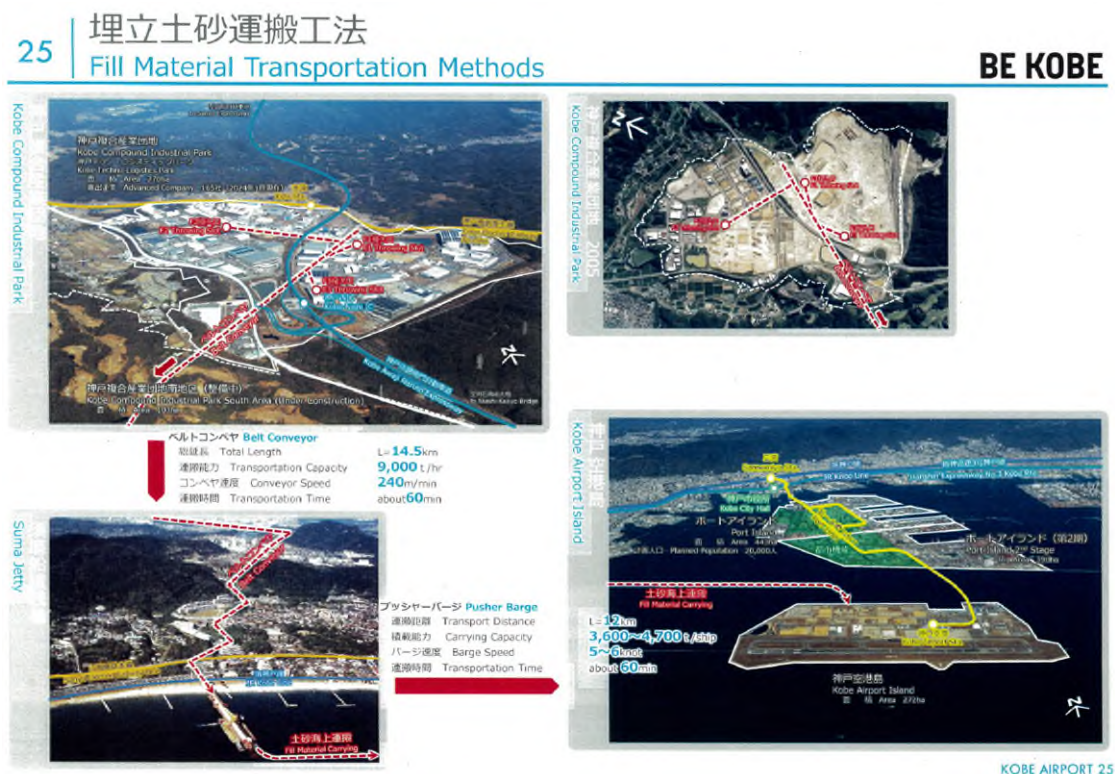
圖 3.2.9 土方陸運流程示意圖
