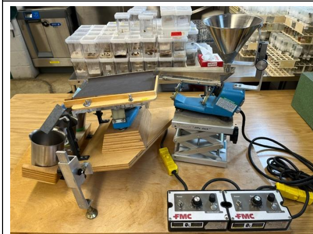
圖 57. 種子分類機器，以重力去將不同重量的種子分離。
