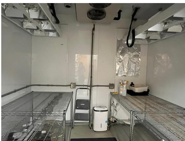
圖 17. 植物生長箱可進行光照試驗，上方為高壓鈉燈，可手動拉下調整與植株的距離。
