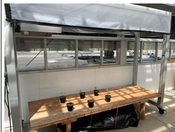
圖 9. 高通量影像辨識系統，由荷蘭廠商製造，可手動移動至合適位置，電腦系統呈現常見的表型特徵，如葉長、葉寬、葉色、葉幅、株高等。
