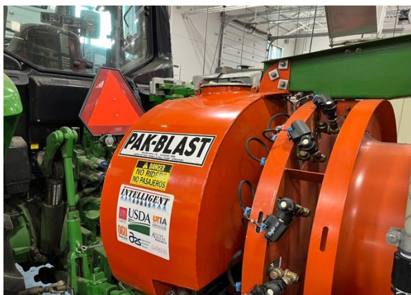
圖 13. 智能農藥自動噴灑機器，由曳引機裝載，透過影像辨識行株距，自動啟動及暫停噴施，達到節能省肥的效益。
