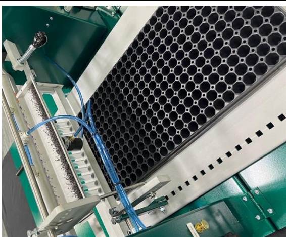
圖 45. 自動播種機，共有十幾種吸嘴可吸取不同大小的種子且可配合穴盤格的數量調整。
