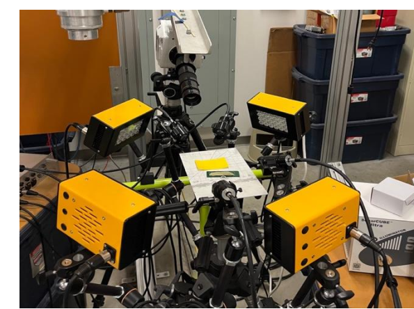
圖 12. 多台高速動態攝影機，捕捉水滴落下的瞬間。
