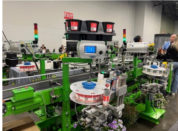
圖 44. 自動標籤機，結合盆花輸送帶，可於傳輸時貼上出貨貼紙，快速便利省工。
