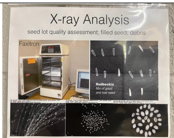
圖 61. 使用 X-ray 判斷種子的稔實度。
