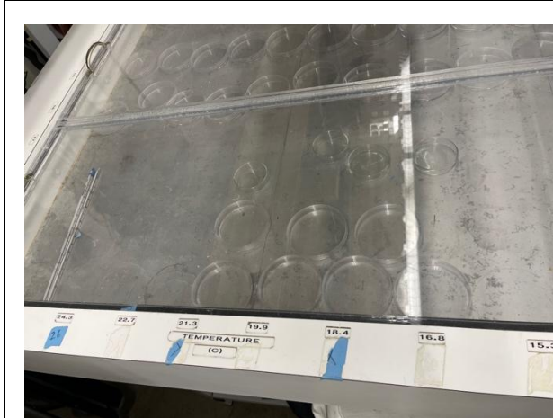
圖 59. 種子發芽測試台，可作控溫處理。
