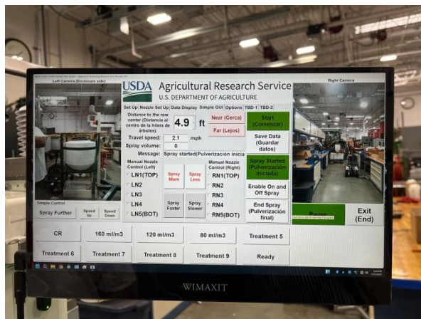
圖 14. 影像辨識可依據植株高度調整噴施位置，以及左右兩側的不同。
