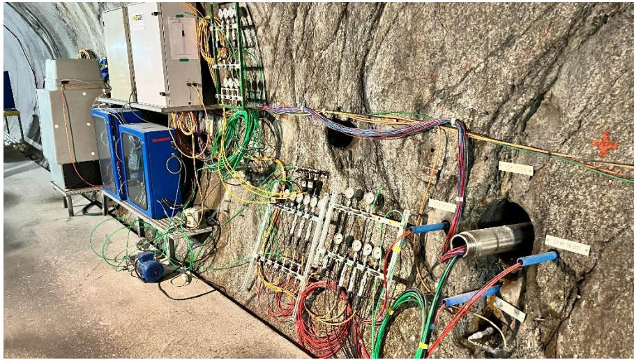
圖 53：CFM 試驗的現地儀器
