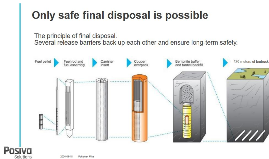
圖 10：芬蘭 Posiva 多重障壁系統(EBS)之示意圖
