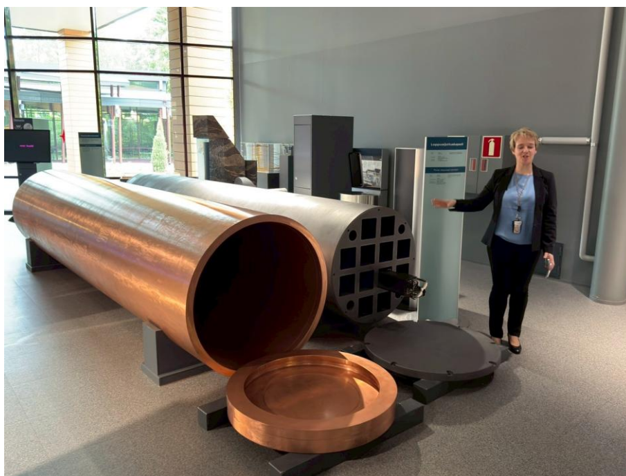
圖 13：實際尺寸之銅殼廢棄物與裝載用過核子燃料的鑄鐵內襯
