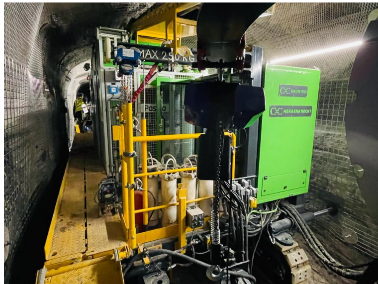
圖 26：處置孔鑽機(DHBM)
