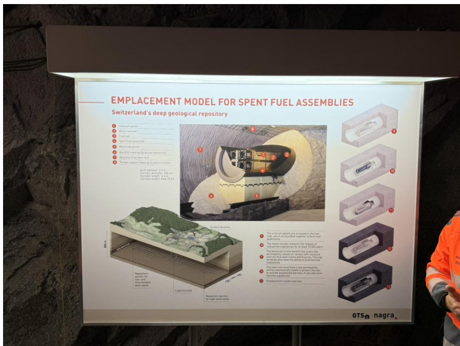
圖 45：瑞士水平處置概念示意圖
