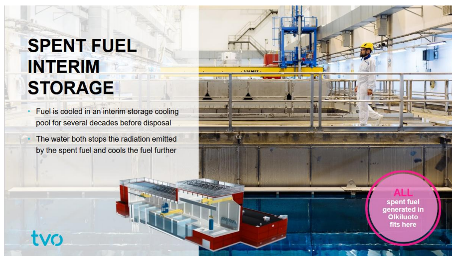
圖 8：用過核子燃料中期貯存設施
