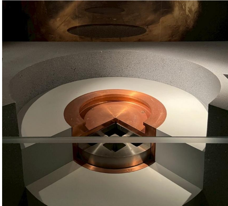
圖 15：鑄鐵內襯、銅殼廢棄物罐及緩衝材料剖面模型
