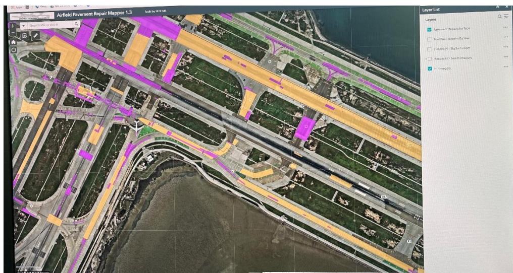
施工管理系統-道面修補歷程畫面
