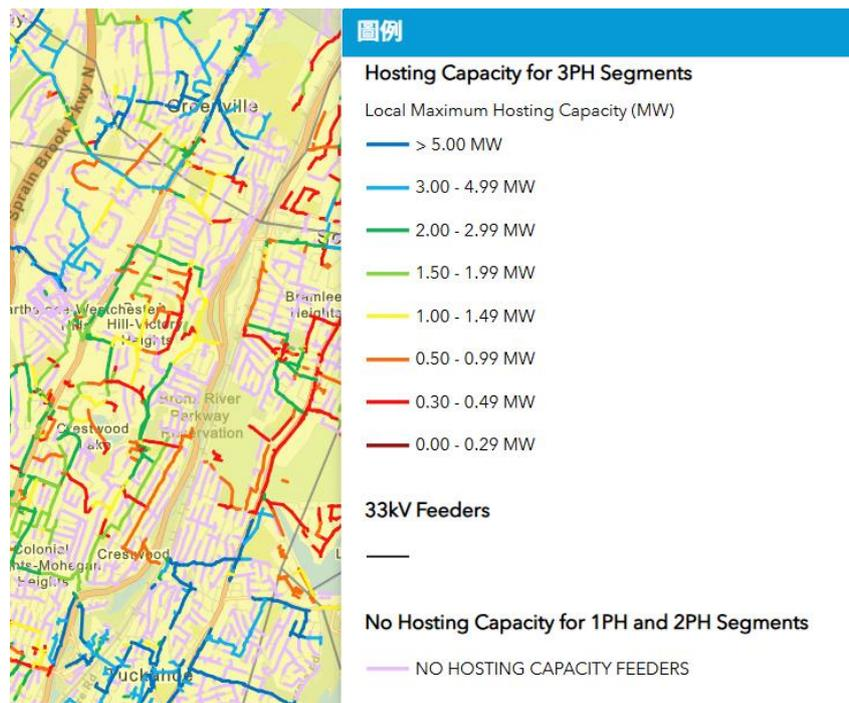
圖13 Hosting Capacity Web Application 中可併網容量的顏色區別
