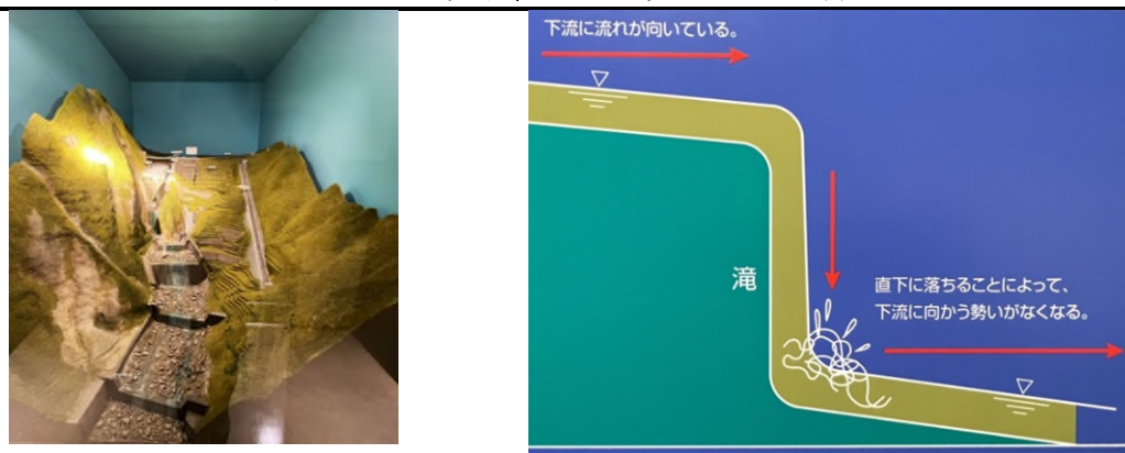
圖 23. 以築壩改善水流和固砂，防止土石流災害
