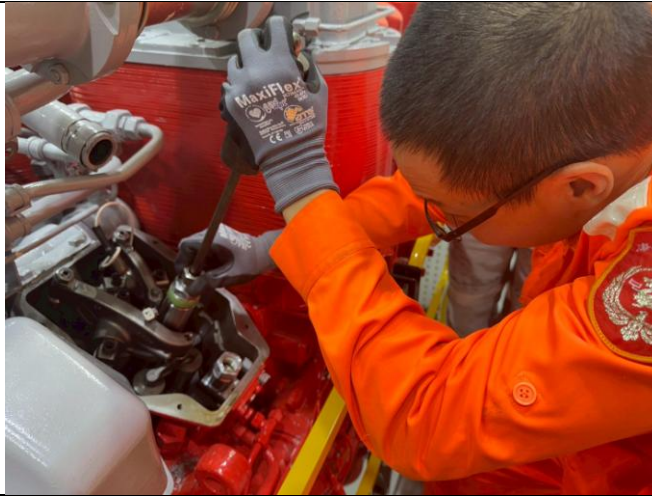
圖 3.1.4-2：噴油嘴拆卸與安裝
