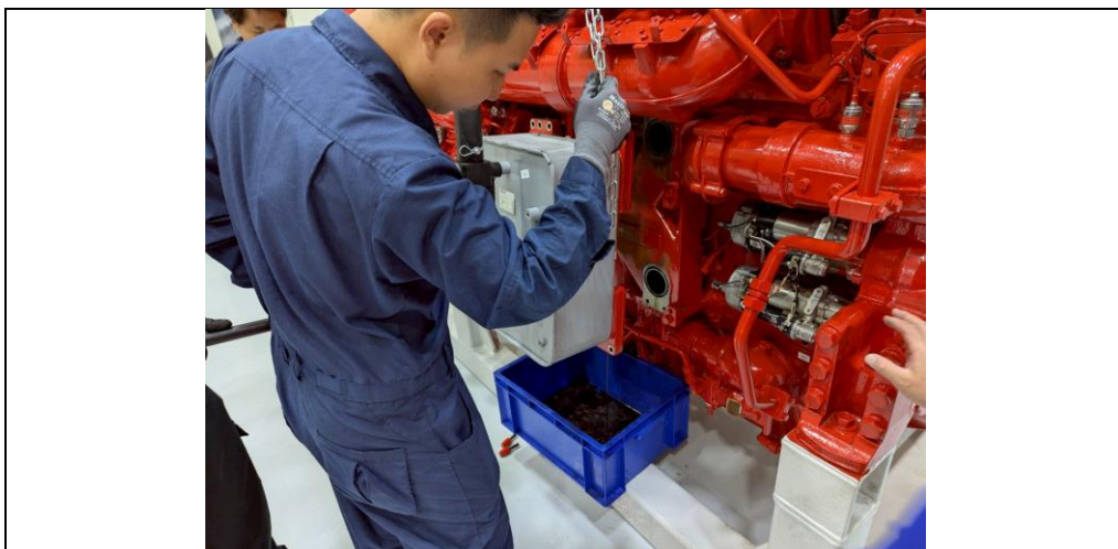
圖 3.1.6-1：滑油冷卻器拆卸與安裝
