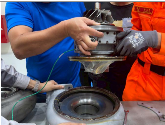
圖 3.2.1-2：渦輪增壓機大部拆解
