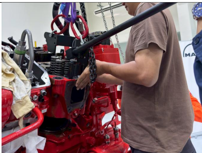
圖 3.2.2-2：缸頭拆除與安裝
