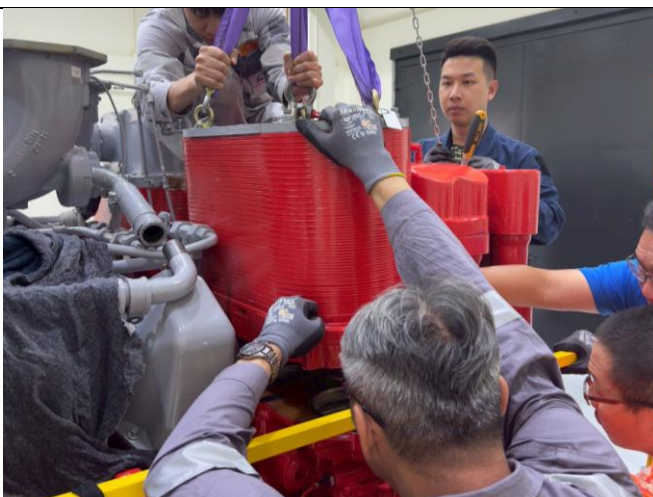
圖 3.2.1-2：渦輪增壓機大部拆解
