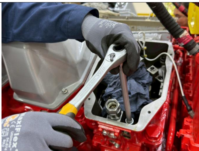
圖 3.2.2-1：搖臂組拆除與安裝
