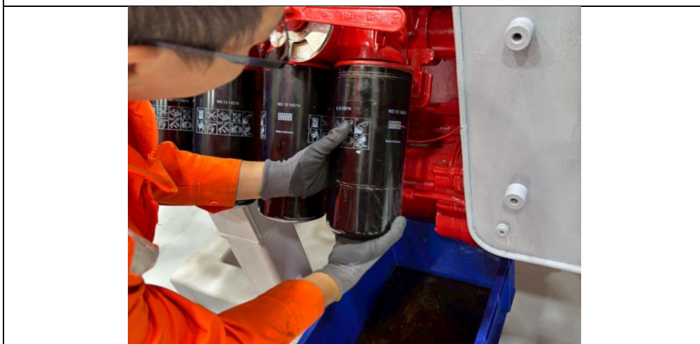
圖 3.1.6-2：滑油過濾器更換
