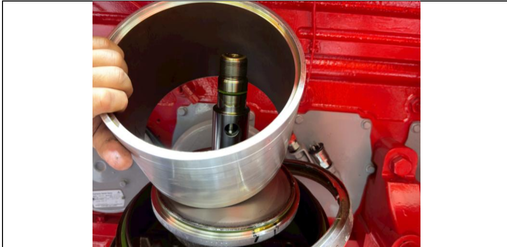
圖 3.1.6-3：離心式滑油過濾器更換濾紙
