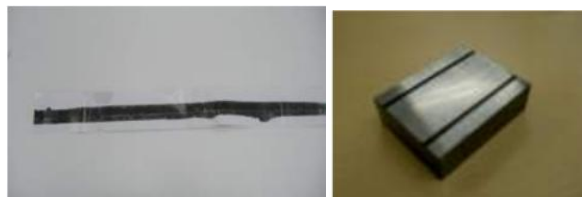
圖 56. 透過印在紙上（左）或是油墨層墨測量儀（右）檢查墨層厚度
