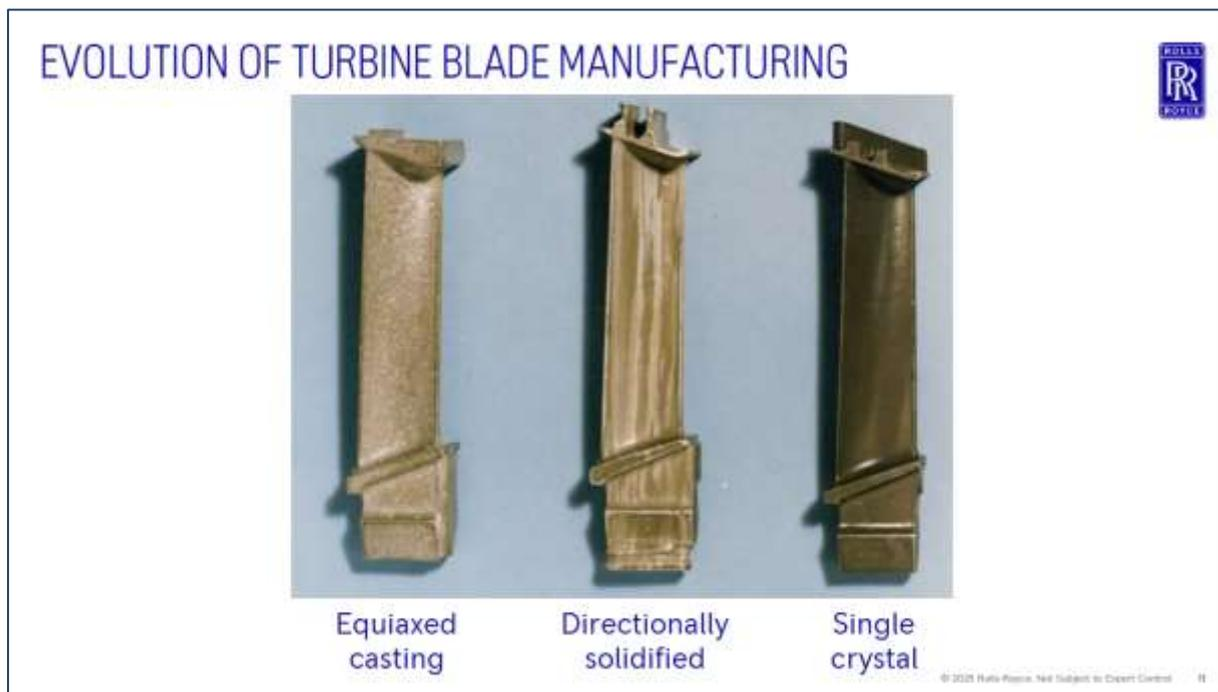
圖 3-9 發動機葉片在製造上的進步
