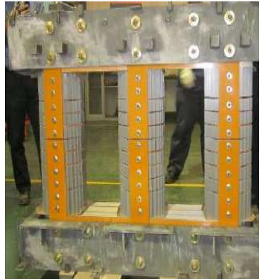
圖 3-10 直線型軛鐵實例圖
