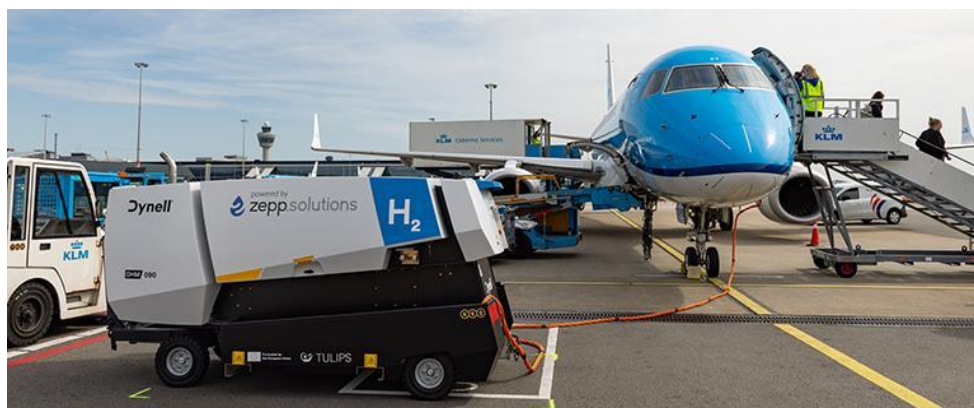
圖 2：史基浦機場使用氫能電源車（GPU） （資料來源：Royal Schiphol Group）
