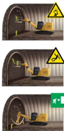
(a) 傳統鋼支保組立
