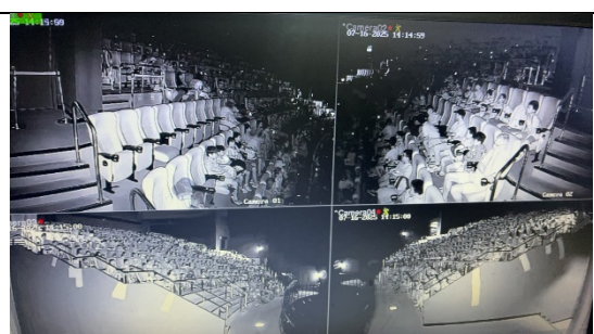
圖 4-2 目前海科館海洋劇場僅有 4 座固定鏡頭式的紅外線攝影機，僅瞭解電影廳內人數
