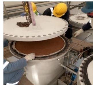
圖七 國外工廠碳分子篩開槽作業的情形
