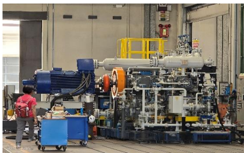
圖八 SIAD 往復式壓縮機測試平台
