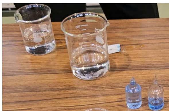
圖 38 左：測試水中臭氧、右：臭氧檢測樣態（左瓶：成功，右瓶：失敗）
